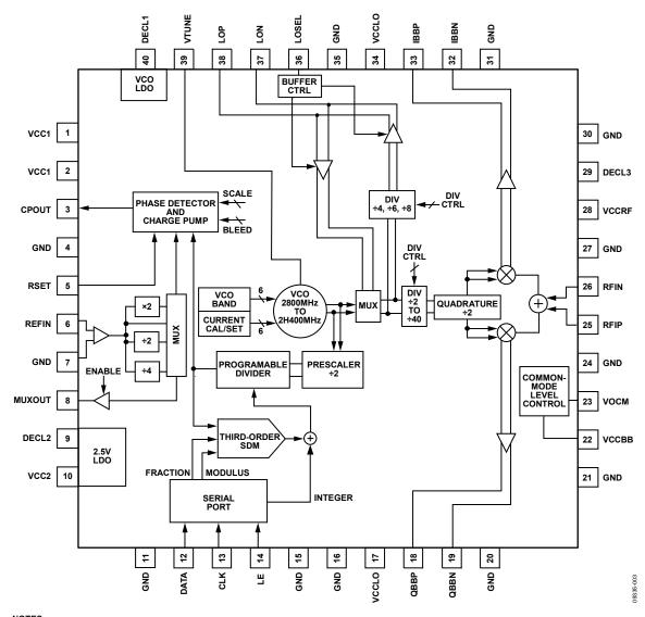
NOTES 1. THE EXPOSED PADDLE SHOULD BE SOLDERED TO A LOW IMPEDANCE GROUND PLANE.
